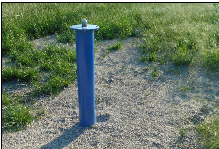
Obr.č. 10: Foto vrtů řady PZH určené k režimnímu sledování vodních stavů
